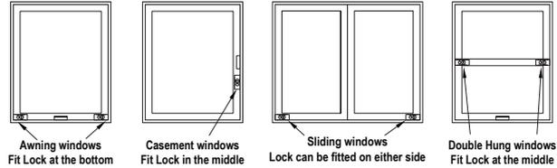
**SAME INSTALLATION PROCEDURE APPLIES TO ALL WINDOW TYPES. THE ONLY DIFFERENCE IS LOCATION OF LOCK.**
